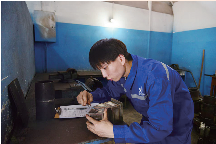
袁玉正在测量焊缝宽度。
