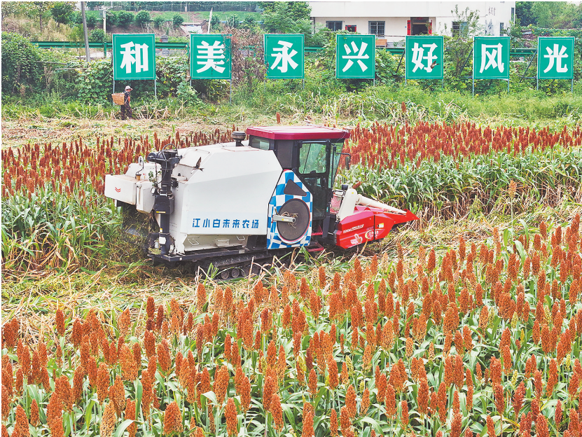
联合收割机正在进行无人化作业。
